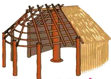
Capanna con struttura di legno, canne, paglia
